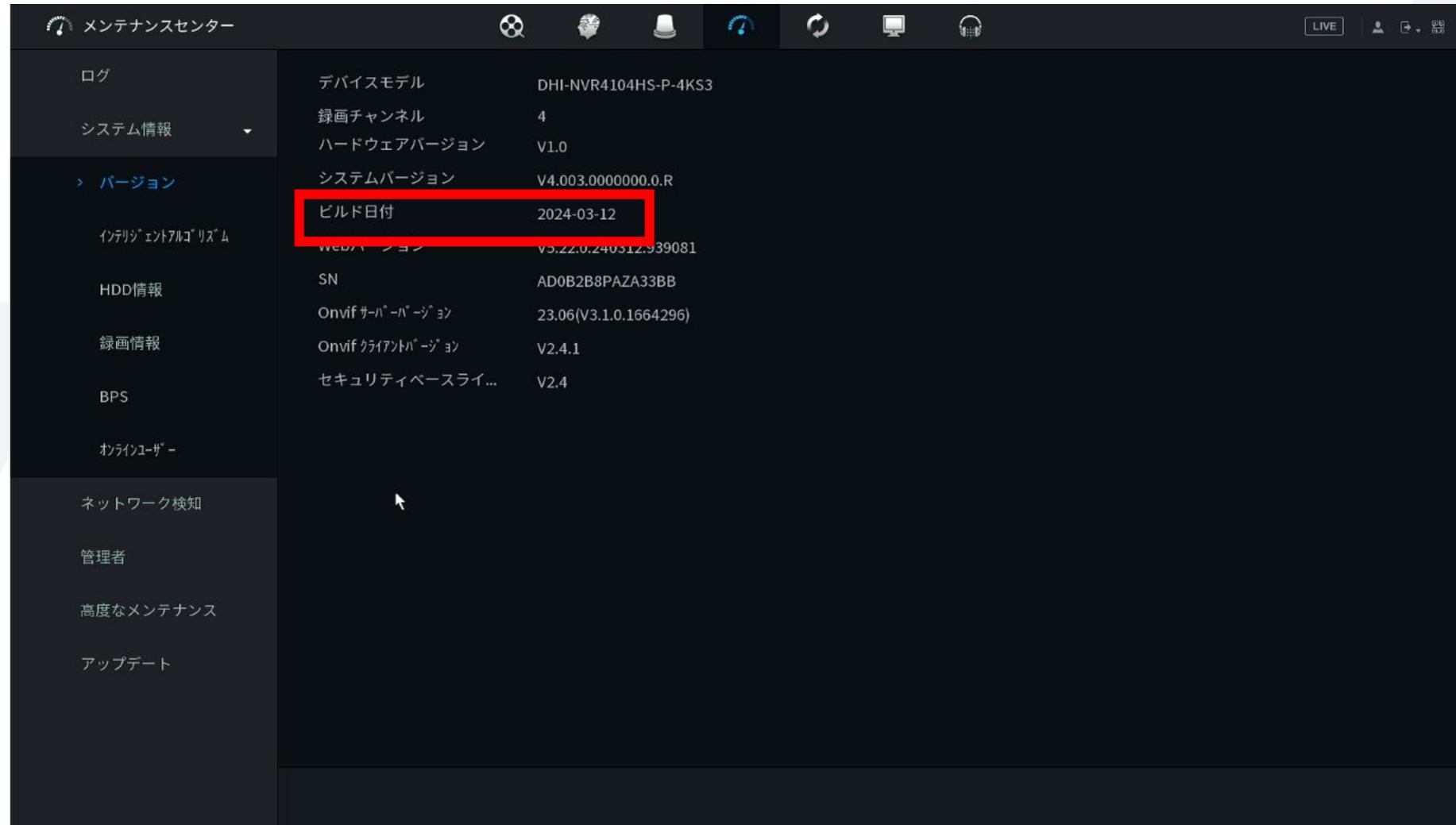
The screenshot shows the 'メンテナンスセンター' (Maintenance Center) interface. The left sidebar contains navigation options: ログ, システム情報, バージョン, インテリジェントアルゴリズム, HDD情報, 録画情報, BPS, オンラインユーザー, ネットワーク検知, 管理者, 高度なメンテナンス, アップデート. The main area displays system information for device model DHI-NVR4104HS-P-4KS3. The 'バージョン' (Version) section is expanded, showing the following details:
